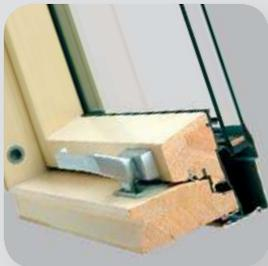
Les fenêtres **en bois** naturel sont d'une qualité supérieure. La menuiserie en pin est composée de lattes, collées ensemble par assemblage à micro-denture. La menuiserie est imprégnée sous-vide et est pourvue de 2 couches d'acrylique transparent.
