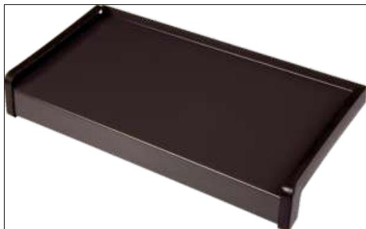
Les seuils de fenêtre extérieur en aluminium "PZA" sont en tôle d'aluminium, revêtus de polyester. Les seuils de fenêtre en aluminium sont formés par une flexion à froid dans des machines à bords. Ils se caractérisent par une très bonne qualité et une résistance aux conditions climatiques. Ils sont esthétiques et durables, résistent à l'humidité, aux produits chimiques, sont ininflammables. Bien installés, ils protègent la façade des bâtiments des pluies et drainent l'eau.
