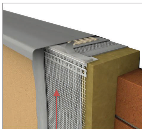
Cornières LX-SPP pour dessous seuils avec joint compribande intégré
