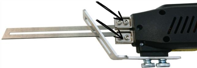
2. Klemmschrauben mit Sechskantschlüssel lösen, Schneidklinge einschieben und Klemmschrauben wieder festziehen.
