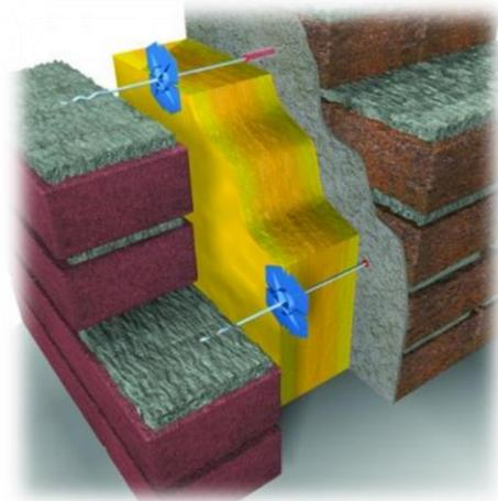
**Application:** Pour la fixation, la stabilisation des plaques d'isolation thermique en fonction de leur épaisseur, la création d'espaces de ventilation et de drainage pour protéger le matériau d'isolation thermique de l'eau entrant dans le système.
