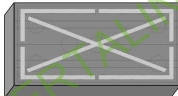
Voor de bevestiging van KNAUF Therm ETIXX Facade λ 31 platen wordt naast de lijm laag aanbevolen om mechanische connectoren met een metalen of plastic pin te gebruiken. De installatielocaties van de mechanische connectoren zijn gemaakte op de bovenzijde van de printplaat. In de onderstaande afbeelding worden voorgestelde locaties voor het gebruik van pins weergegeven:
