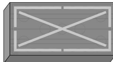
Oprócz warstwy kleju do mocowania płyt KNAUF Therm ETIXX Fasada λ 31 zaleca się użycie łączników mechanicznych z trzpieniem metalowym lub z tworzywa sztucznego. Minimalna ilość łączników powinna wynosić 4szt./m<sup>2</sup>. Na wierzchowej stronie płyty zaznaczono miejsca montażu łączników mechanicznych. Proponowane miejsca zastosowania kołków przedstawia poniższa grafika:
