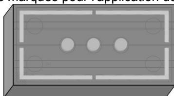
Dans le cas de la colle polyuréthane, le schéma de collage ressemble à ci-dessous :
