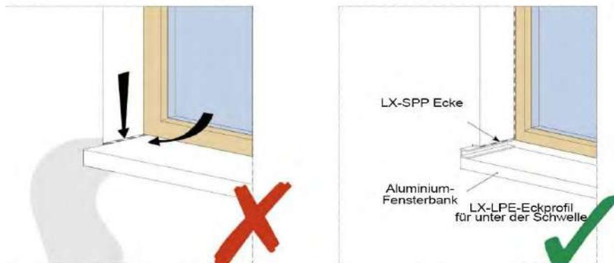
**Für die Seiten der Schwelle** ist die Verwendung des **LX-SPP-Winkels zwingend erforderlich**:
