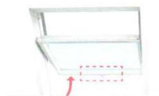
**B** Fenêtre avec la poignée en bas: Ouvrez la fenêtre en tournant la poignée en position verticale. Les ressorts de friction utilisés dans les charnières permettent d'arrêter le châssis dans n'importe quelle position d'ouverture.
