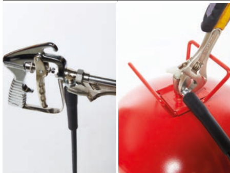
Connecter le grand écrou du flexible au pistolet de pulvérisation et l'écrou plus petit à la bonbonne. Vérifier que le flexible est raccordé de manière sûre à ses deux extrémités.
