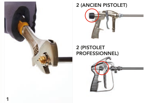
S'assurer que la buse de pulvérisation est positionnée et serrée correctement (1), et que la vis de réglage est fermée (2).
