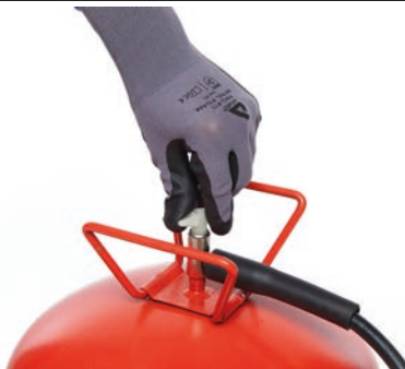
Tourner dans le sens anti-horaire, la valve blanche de la bonbonne, jusqu'à ouverture. Ne pas fermer la valve tant que la bonbonne n'est pas vide (afin d'éviter que la colle présente dans le flexible et le pistolet ne sèche).
