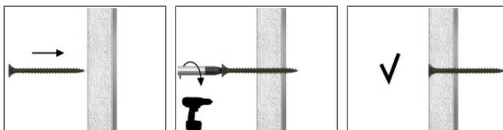
1. Serrez la vis perpendiculairement au sol jusqu'à ce que la surface de la tête rencontre le sol
