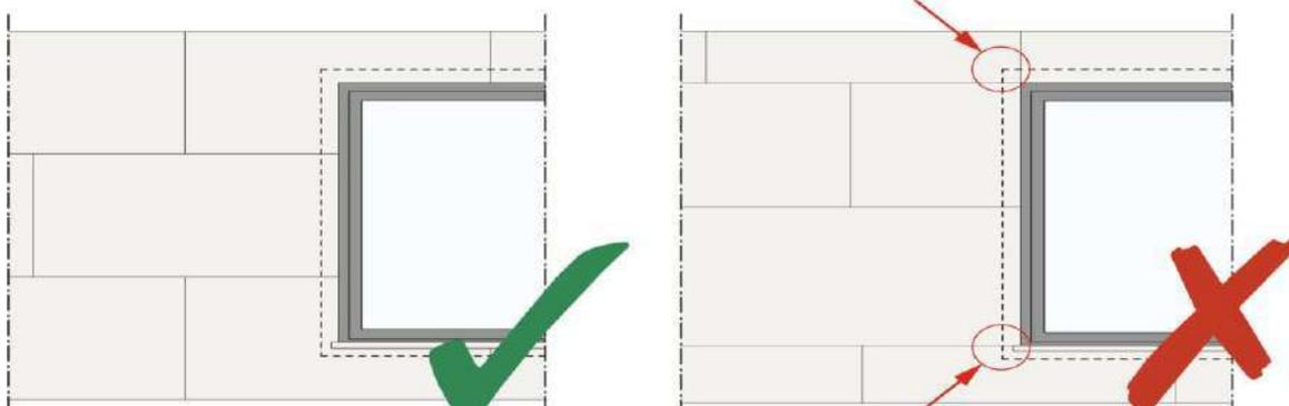
Colocação de painéis EPS Adam Matériaux numa única peça nos cantos dos vãos para limitar o risco de fissuras
