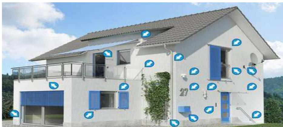
Após a colagem dos painéis EPS Adam Matériaux, é necessário instalar blocos para fixar os novos estores, persianas e toldos após a instalação da fachada e do sistema de reboco Adam Matériaux Etics.
