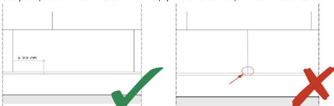
Ausência de junta entre os painéis EPS Adam Matériaux na junção do ângulo inicial ALU ou do ângulo PVC
