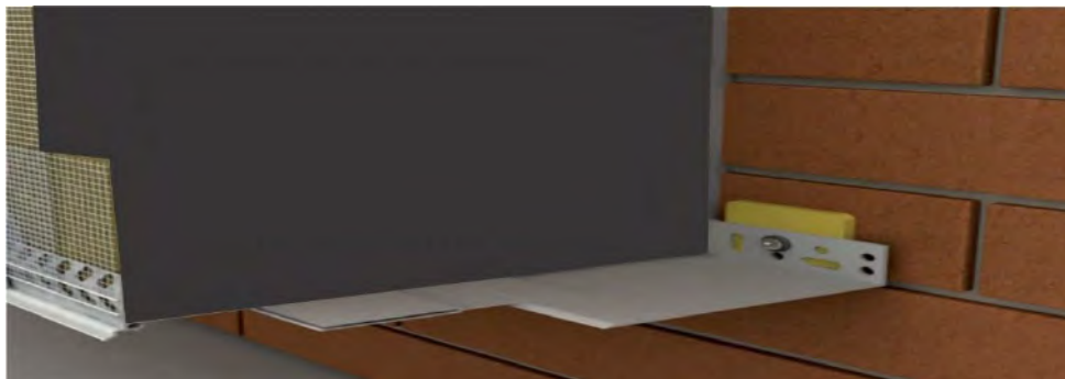
Adam Materiaux EPS HD-Isolierung + LW-206-Winkel + LZ 23-Winkel + LW-L-Winkel
