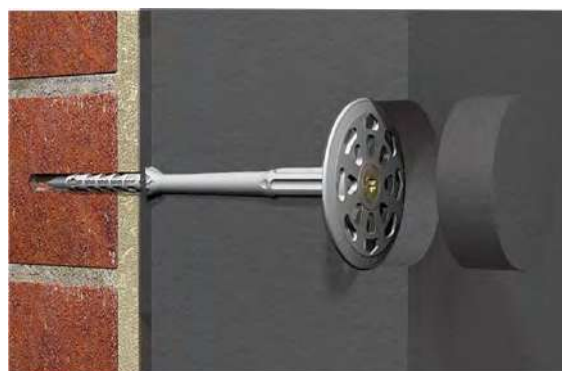
EPS 65mm Dübel diagramm für EPS HD Dübel ADAM Materiaux
